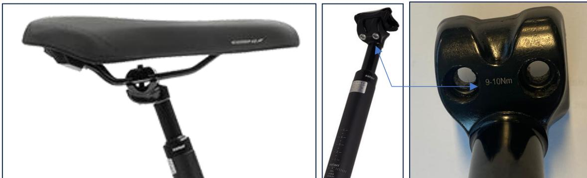
Wir betonen, dass die Sattelstütze und die Schrauben selbst sicher sind und alle Anforderungen erfüllen. Dies ist nur eine Ausnahmesituation, in der die Schrauben viel härter als erlaubt angezogen werden. Das beweisen auch viele Tests, in denen wir über lange Zeiträume auf Bruch geprüft haben. Nur wenn die Schrauben stark überlastet waren, konnten wir einen Bruch simulieren, nie wenn die Schrauben richtig angezogen waren.
